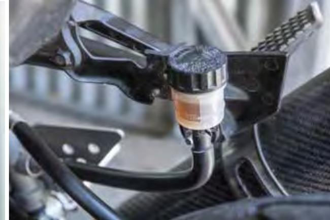
Tubo raccordo tra la pompa freno ed il serbatoio del liquido freni DOT3 - DOT4
